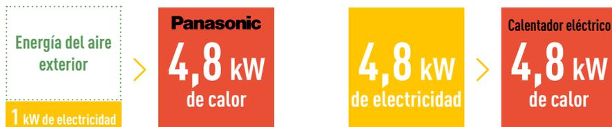
\* COP de 4,8 para modelos CU-2Z35TBE y CU-5Z90TBE; cálculo COP basado en EN14511.
